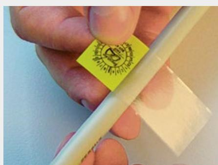
Lösen Sie die Kabelprüfplakette vom Sammelbogen und kleben das Prüfplakettenfeld um das Kabel.
